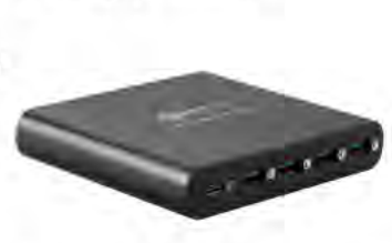
LVSUN LS-Q5U-PD-1 / USB-C Laptop Netzteil / 80W
